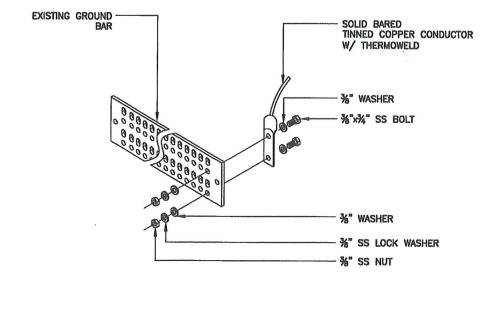
TYPICAL GROUND BAR CONNECTION DETAIL
