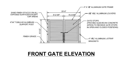
**DUMPSTER AND RECYCLING ENCLOSURE DETAIL**
