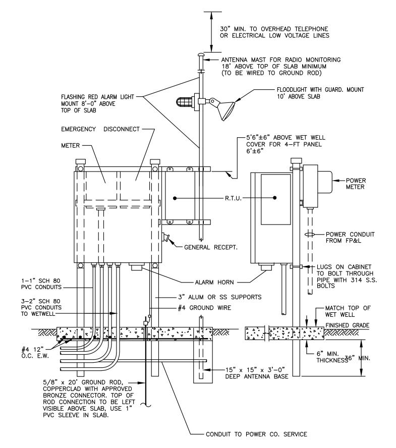
PUMP STATION CONTROL PANEL INSTALLATION DETAIL CITY FIG: 210
